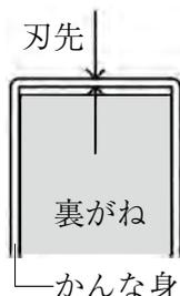
裏がねのかしらを、面に対して垂直にたたく。裏がねの刃先をかな身の刃先より (㉜) )~(㉝) )mmくらいにする。
