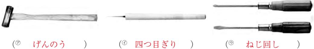
(㊥ くぎ接合) では、四つ目ぎりや卓上ボール盤で下穴をあけ、くぎをげんのうで打ちつけ固定する。(㊦ ねじ接合) では、三つ目ぎりや卓上ボール盤で下穴をあける。(㊧ 木ねじ) は、頭の形状に合わせてプラス・マイナスのねじ回し (ドライバ) を使用して固定する。
